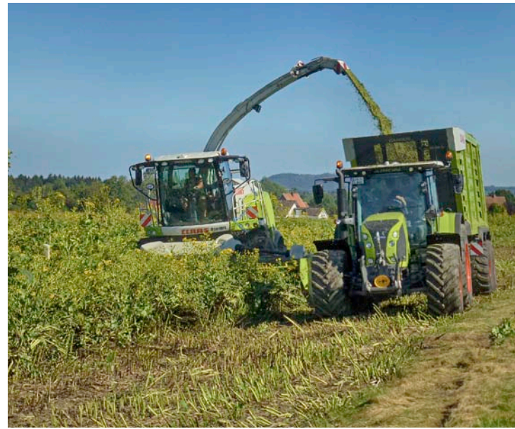
Silphieernte mit dem Maishäcksler mit GPS-Erntevorsatz.
